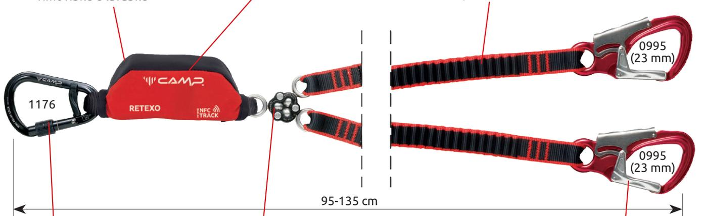
HMS BELAY LOCK Art.1176 Ghiera a vite. Lega d'alluminio. Dotato di leva antirotazione. Carico di rottura 23 kN Apertura 24 mm
