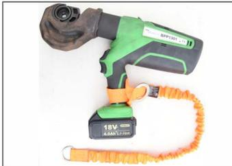
Der runde Metallring an der Werkzeughalteleine TS 90 001 01 dient dazu, das Werkzeug an einem am Benutzer fixierten Verbinder anbringen zu können, wenn das Werkzeug nicht in Gebrauch ist.
