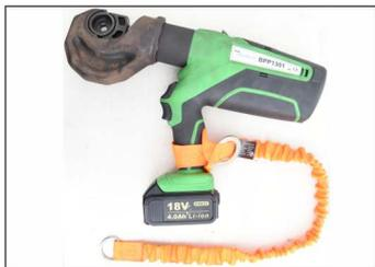
L'anneau métallique rond présent sur la longe porte outils TS 90 001 01 permet d'accrocher l'outil sur un connecteur fixé sur l'utilisateur lorsque l'outil n'est pas utilisé.
