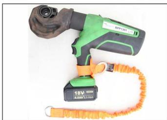
La anilla metálica redonda presente en la eslinga portaherramientas TS 90 001 01 permite enganchar la herramienta a un conector fijado al usuario cuando la herramienta no se usa.
